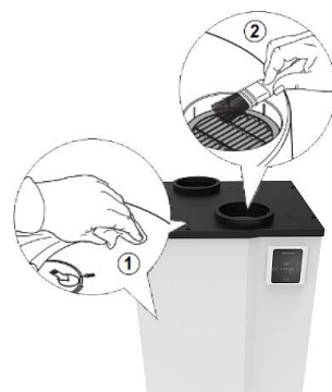
Foto 19: Pulizia di manutenzione dell'ECOHEAT
